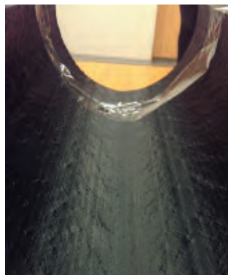
Рис. 2. Труба, изготовленная из ПЭНД, имеющая дефекты в виде закрытых пор на внутренней поверхности
