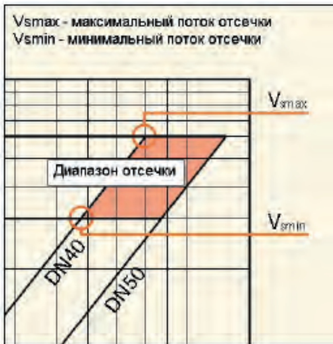
Рис. 3. Пример выбора клапана потока газа по диаграмме
