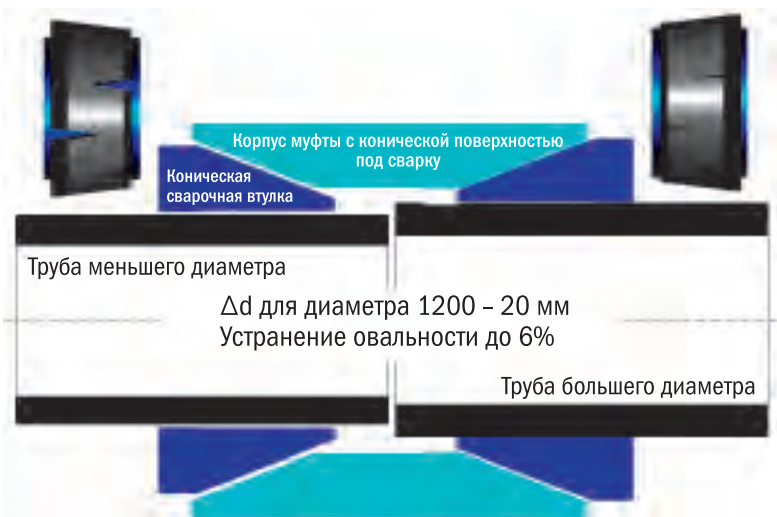
Рис. 7. Возможность сборки труб с разным фактическим диаметром
