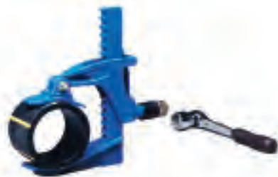
Рис. 7. Струбцина для устранения овальности труб
