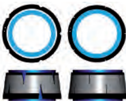
Рис. 6. Принцип работы конической сварочной втулки: разрезы обеспечивают возможность эластичного уменьшения диаметра при заполнении втулкой зазора между трубой и муфтой
