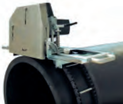
Рис. 9. Цепная электрическая пила для обрезки труб из полимерных материалов
