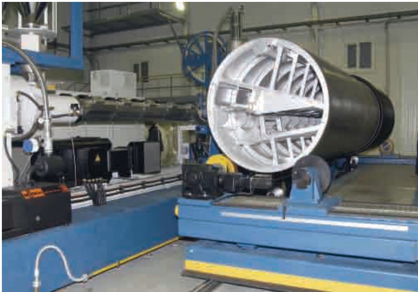
Рис. 2. Установка намотки трубы
