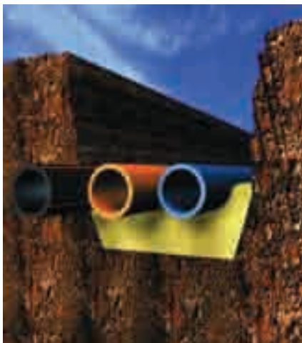
Открытая прокладка в песке
