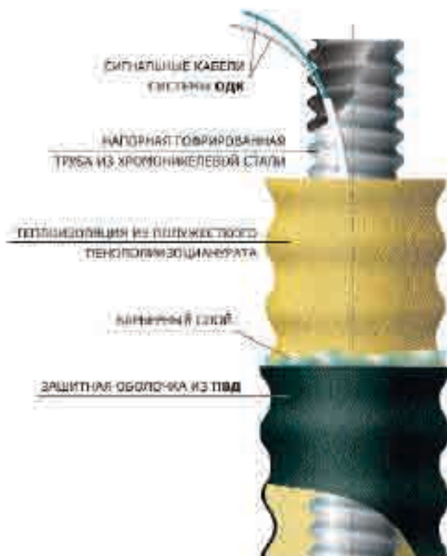
Рис. 1. Конструкция трубы КАСАФЛЕКС
