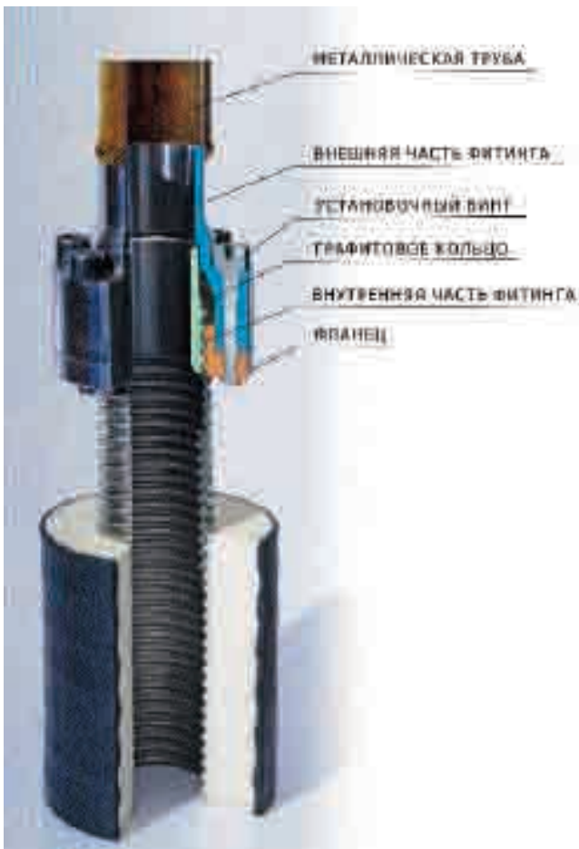
Рис. 3. Конструкция фитинга КАСАФЛЕКС
