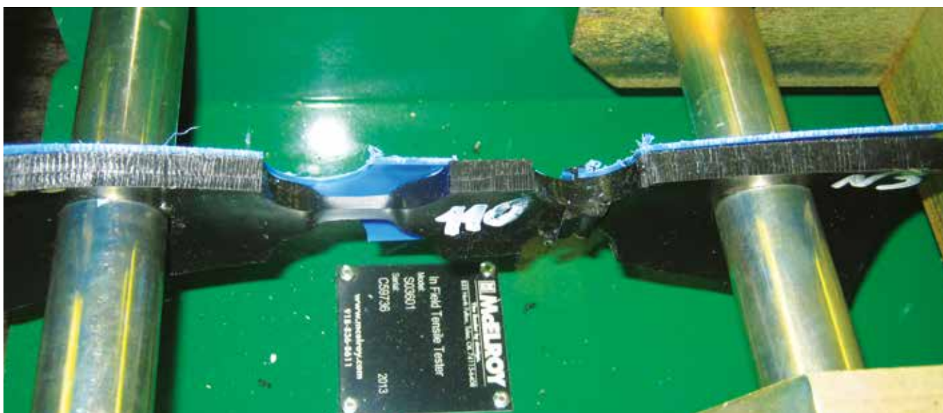
Рис. 3 Пластическое разрушение по месту основного материала трубы. Результат положительный.
