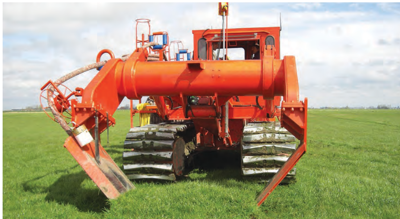
Рис. 3. V-образный дренажный плуг
