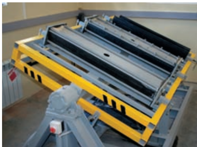
Рис 1. Установка для определения износа труб по методу DIN EN 295-3
