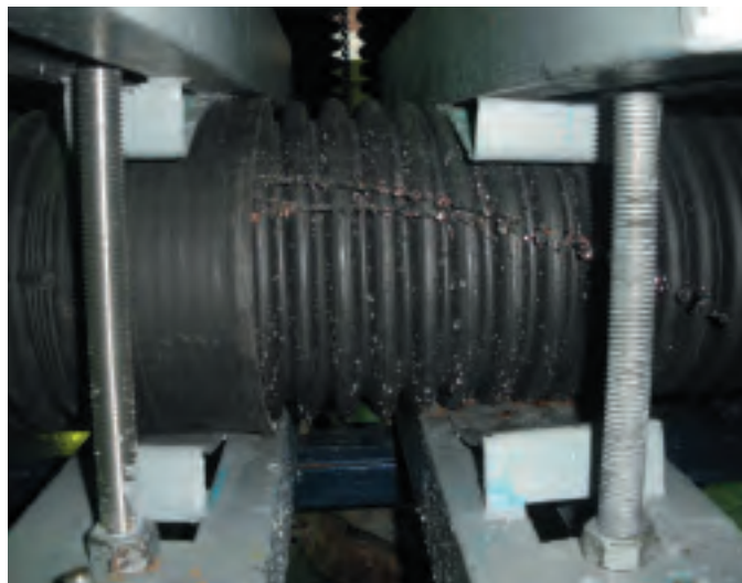
Протечка соединения трубы с формованным раструбом при испытании на герметичность в соответствии с EN 13476-3
