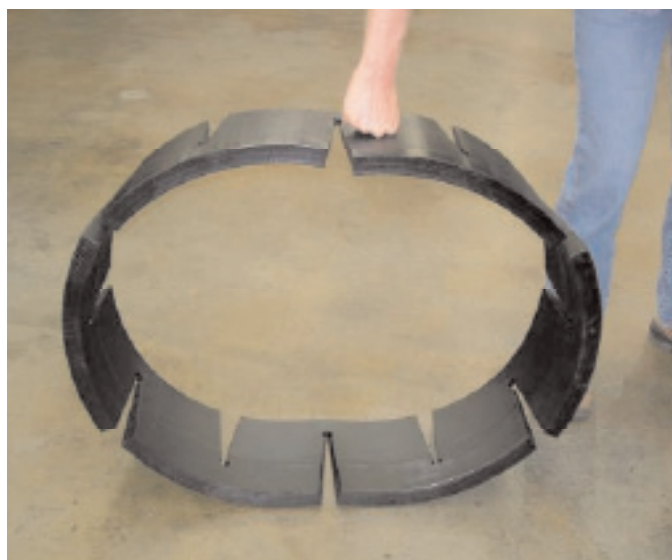
Рис. 2. Эластичность конической сварочной втулки упрощает ее установку на трубы с большим отклонением от округлой формы
