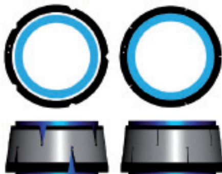
Рис. 6. Принцип работы конической сварочной втулки: разрезы обеспечивают возможность эластичного уменьшения диаметра при заполнении втулкой зазора между трубой и муфтой
