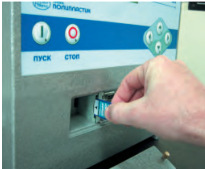
Рис. 4. Современная TRASSA M записывает протоколы сварки на SD-карту
