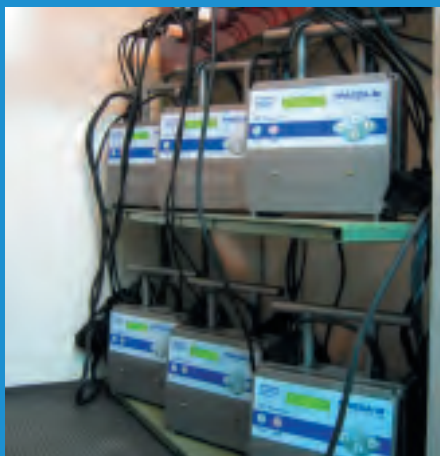
Рис. 6. Аппараты проходят испытания в климатической камере
