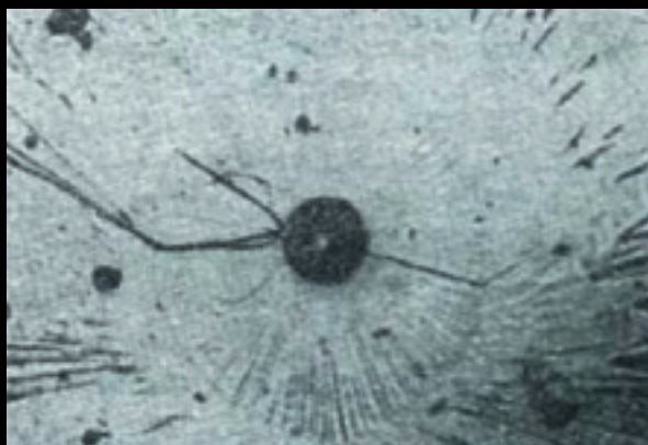
Рис. 2. Начало разрушения, вызванного пузырьком воздуха, и область распространения трещин (x158)
