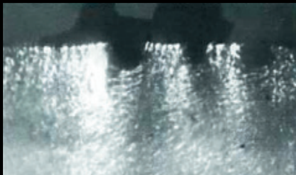
Рис. 7. Разрушение поверхности стеклопластиков при старении
