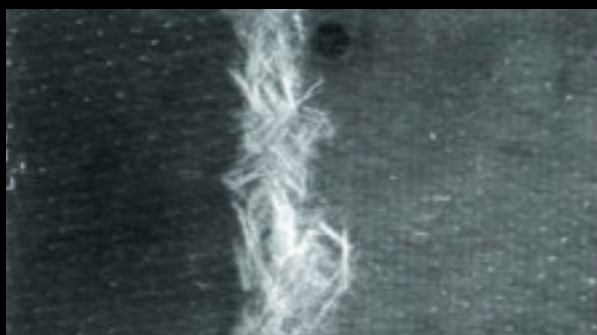
Рис. 6. Внешний вид образцов стеклопластика после 2,5 лет испытания под действием климатических факторов (УФ-облучение, вода, абразивный износ)
