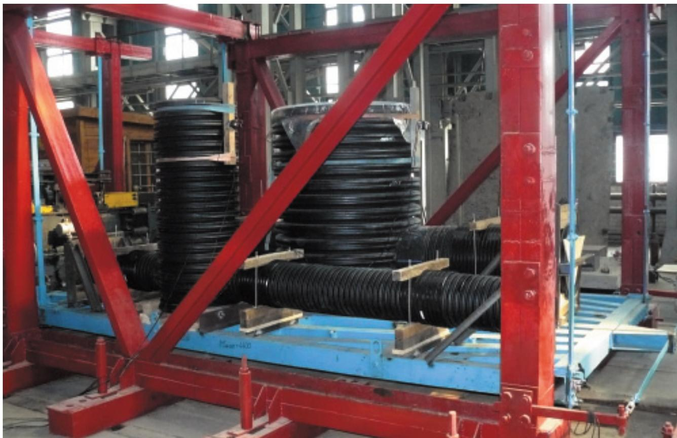
полиэтиленовых колодцев диаметром 630 и 1200 мм и труб КОРСИС диаметром 315 и 500 мм соответственно. Трубы при помощи муфт с уплотнительными кольцами были присоединены к патрубкам колодцев. Свободные концы труб были заглушены. При испытаниях трубы и колодцы были заполнены водой.
