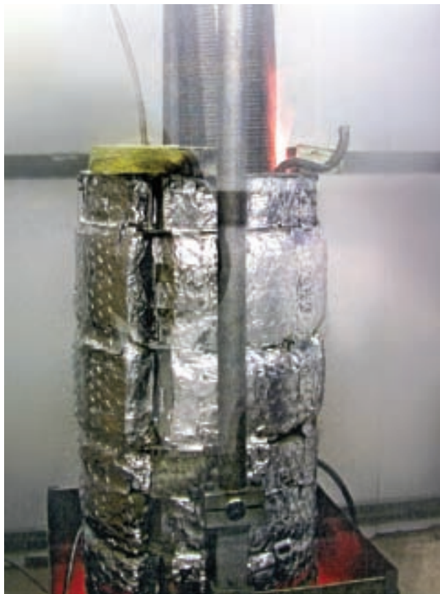
Рис. 1. Установка ВНИИПО для испытаний на распространение пламени теплоизоляционных конструкций промышленных трубопроводов
