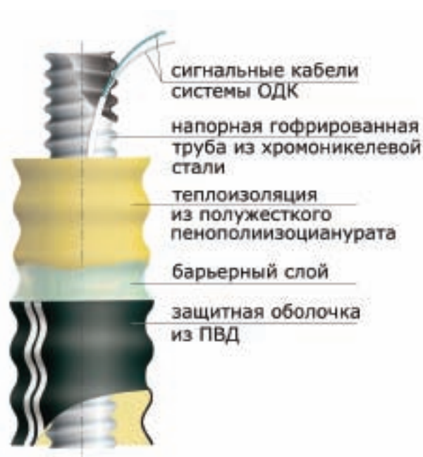
Рис. 2. Труба КАСАФЛЕКС
