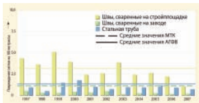
Рис. 3. Классификация повреждений стальных труб
