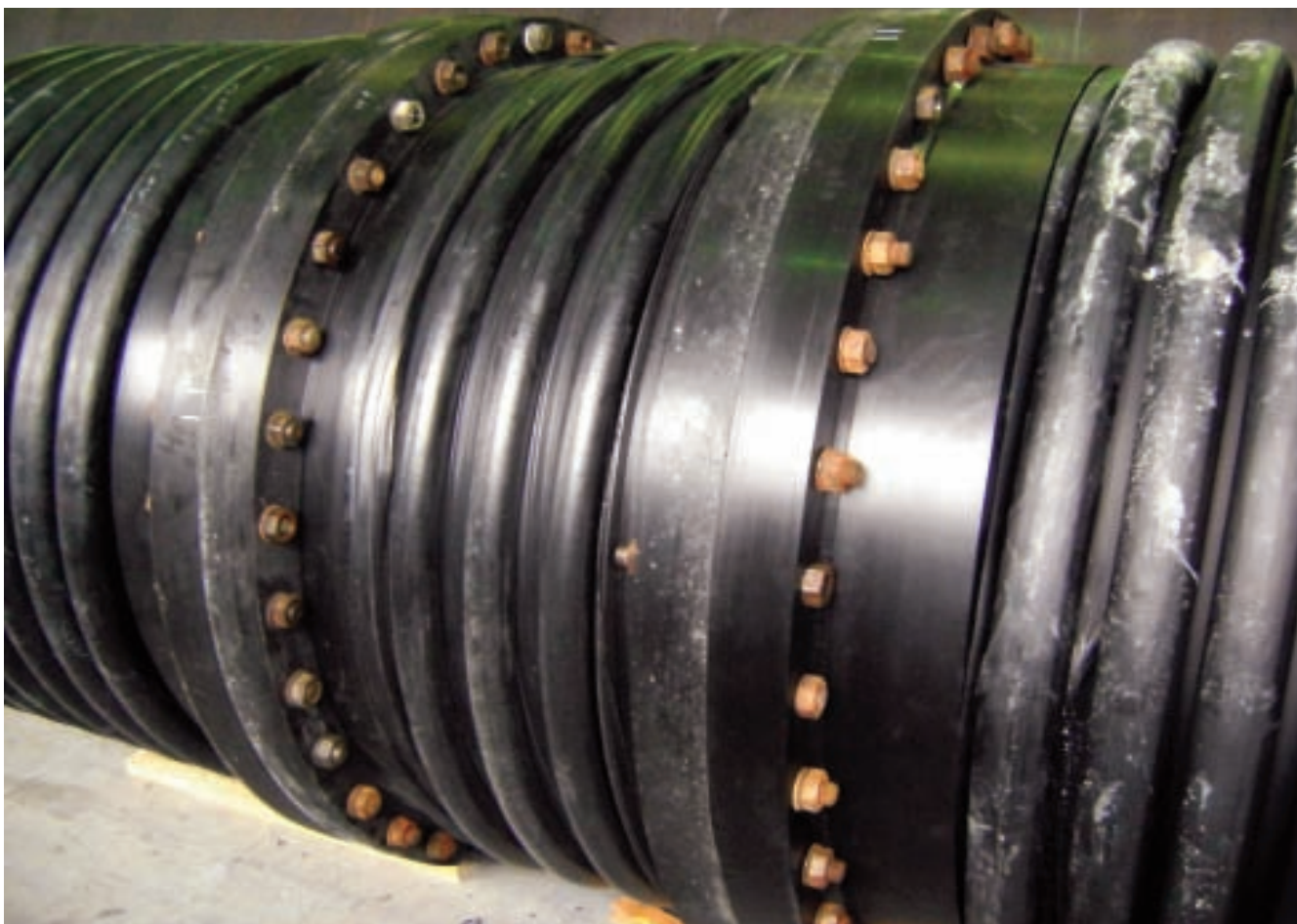
Рис. 4. Восстановленный трубопровод КОРСИС ПЛЮС
