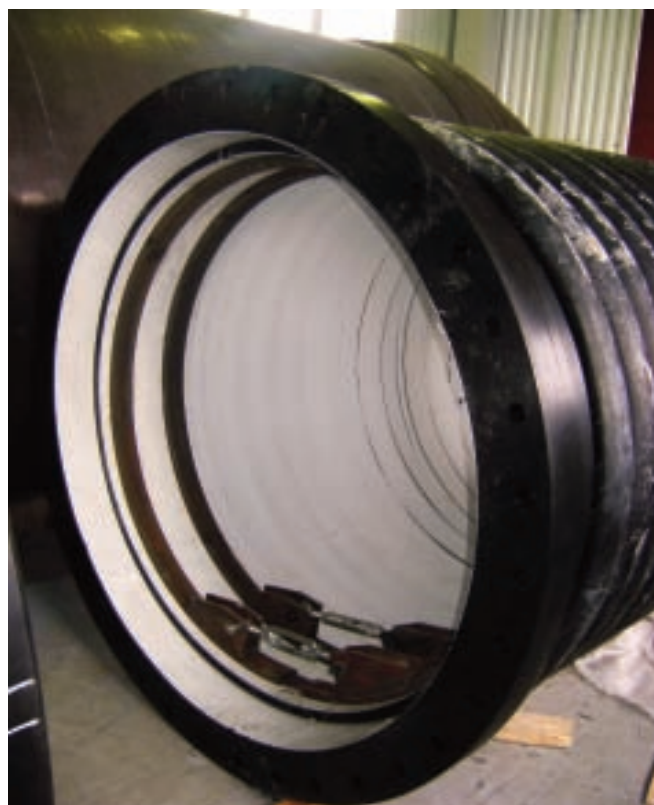
Рис. 2. Втулка под фланец, привариваемая с помощью ремонтного электрофузионного вкладыша
