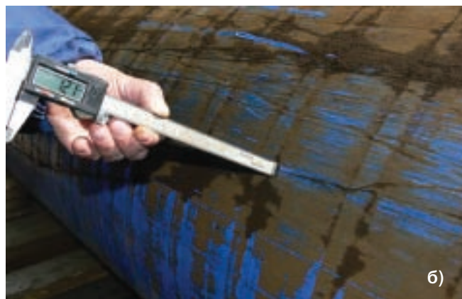
Рис. 5. Глубина царапин на поверхности трубы из ПЭ 100 (а) и в защитном слое многослойной трубы (б)
