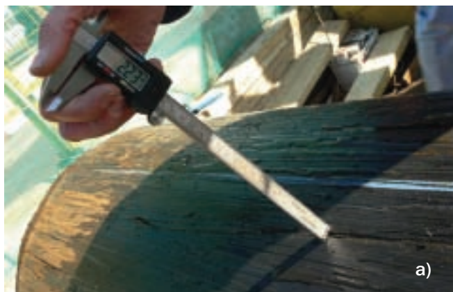
Рис. 5. Глубина царапин на поверхности трубы из ПЭ 100 (а) и в защитном слое многослойной трубы (б)
