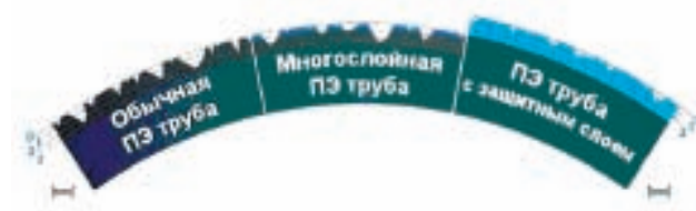
Рис. 4. Устойчивость разных типов полиэтиленовых труб к повреждениям при протяжке
