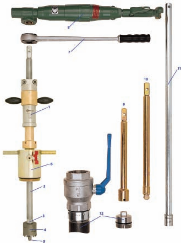
Рис. 2. Комплект для выполнения врезок и установки заглушек
