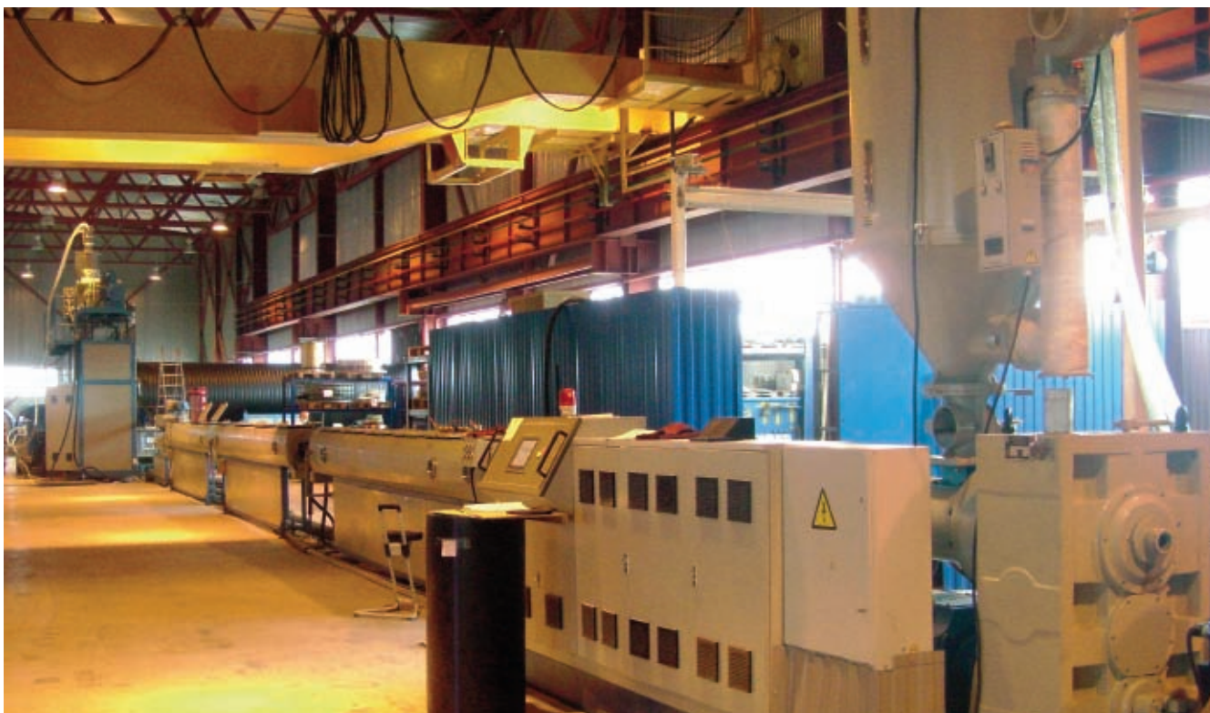
Рис. 2. Линия SKRG-2400 для производства витых труб HDPE большого диаметра
