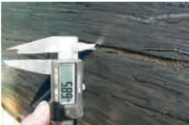
Рис. 2. Замер ширины царапин на образце № 1.
