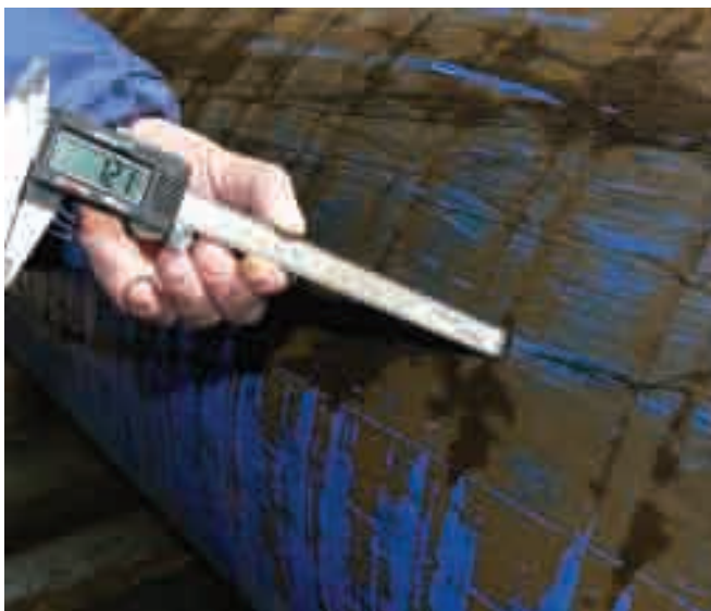
Рис. 4. Замер глубины царапин на образце № 2.
