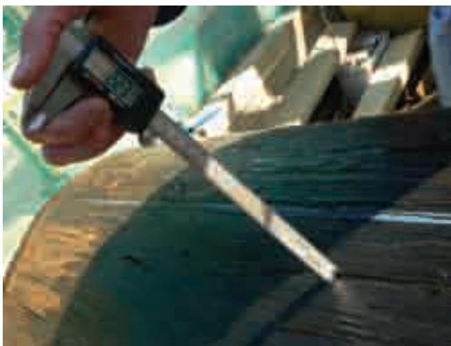
Рис. 3. Замер глубины царапин на образце № 1.
