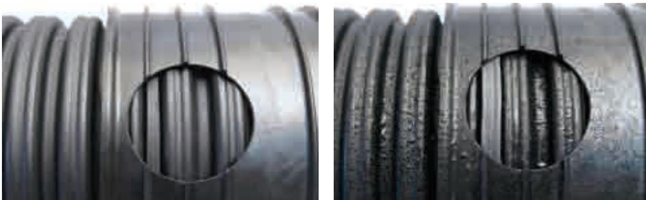
Рис. 3. Ремонтный уплотнитель ECOPAL до и после увлажнения
