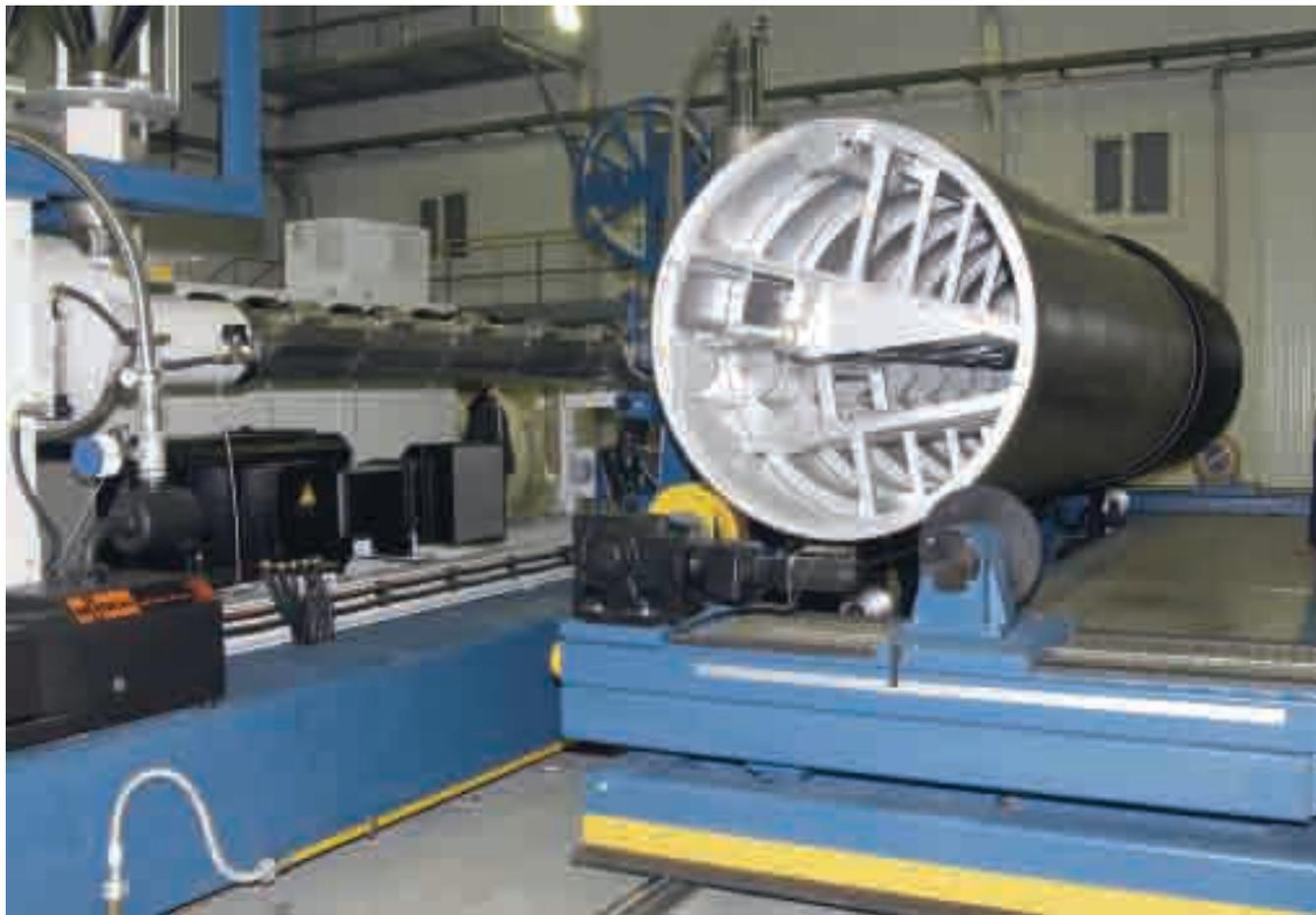
**Рис. 2. Установка намотки трубы**
