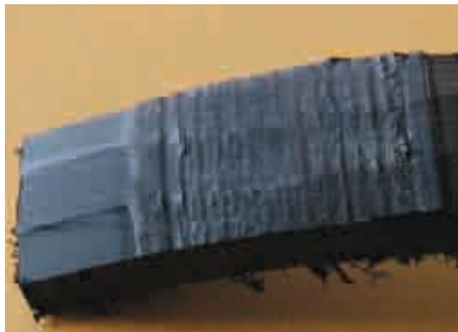
Рис. 5. Образец неравномерного снятия оксидного слоя (с образованием граней)
