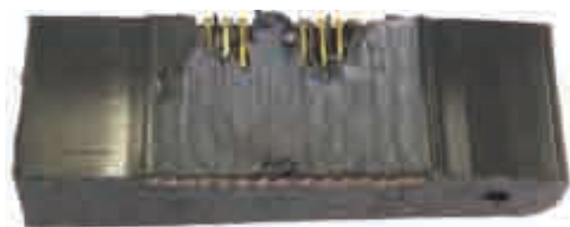
Рис. 3. Образцы вязкой поверхности после испытания на отдир
