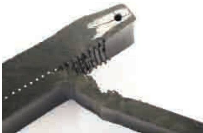
Рис. 2. Вязкая поверхность после испытания на отдир
