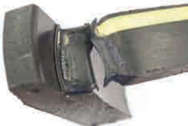
Рис. 1. Трещина в трубе во время испытания на отдир. Образец классифицирован, как вязкий
