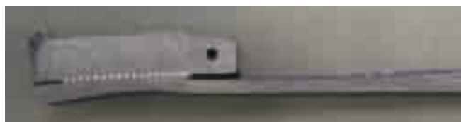
Рис. 6. Образец избыточного снятия оксидного слоя (большой зазор)
