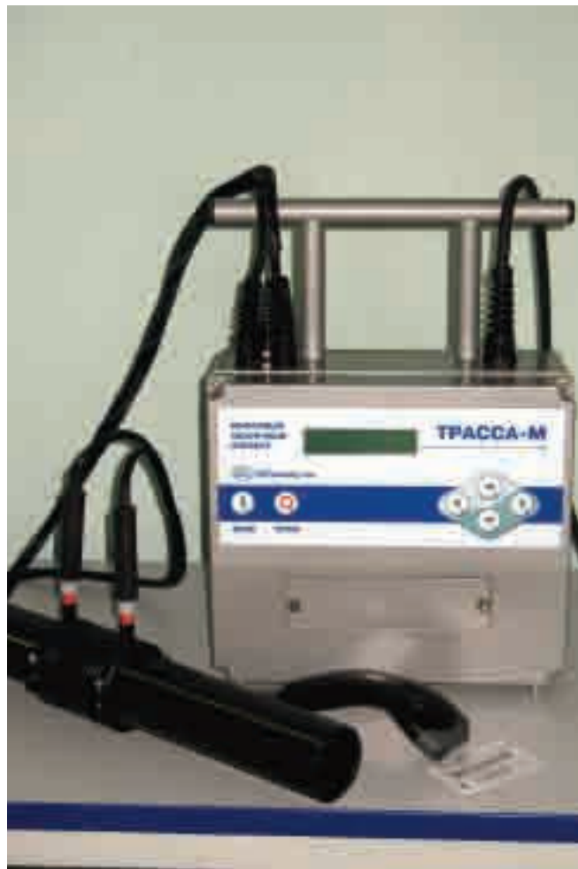
Рис. 4. Сварочный аппарат ТРАССА-М (производитель – ООО «Чебоксарский трубный завод»)
