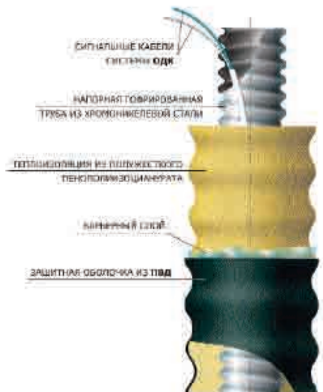
Рис. 1. Конструкция трубы КАСАФЛЕКС
