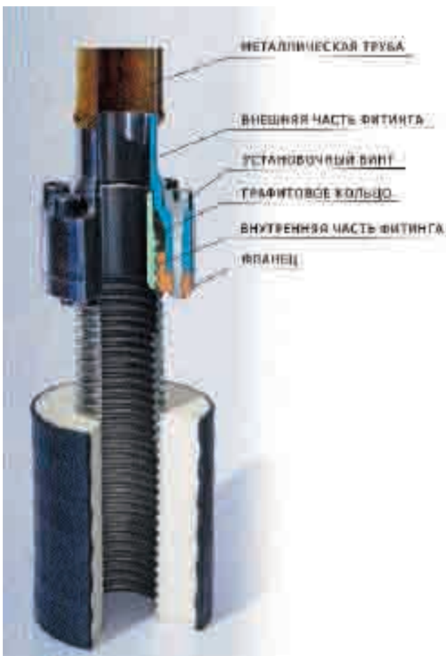
Рис. 3. Конструкция фитинга КАСАФЛЕКС
