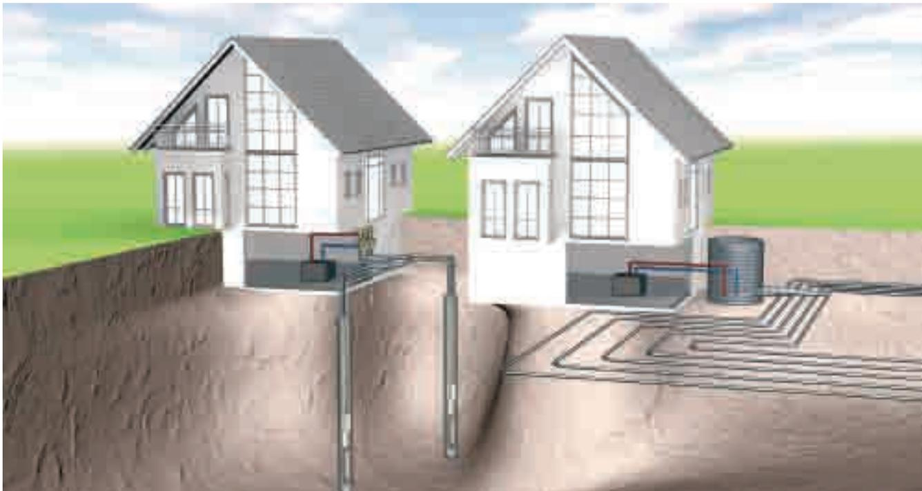
Тепло грунта, находящегося ниже глубины промерзания, – постоянный источник энергии, которую можно использовать независимо от погоды и времени года. В Центральной Европе эту энергию можно извлекать с глубины начиная приблизительно с 1,2 метра.
