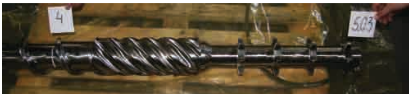
Рис. 4. «Гомогенизирующая» зона шнека
