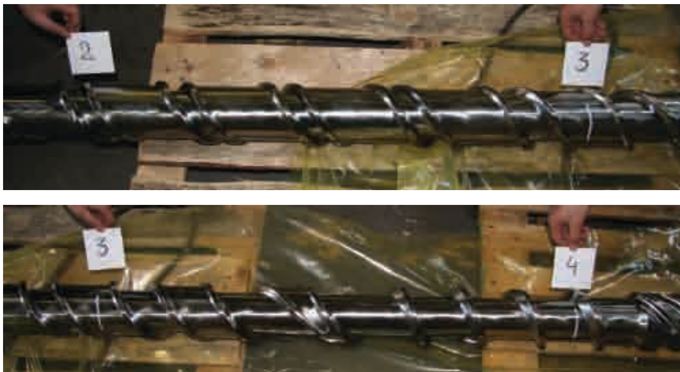
Рис. 2. «Барьерная» зона шнека (заканчивается в середине нижней фотографии)
