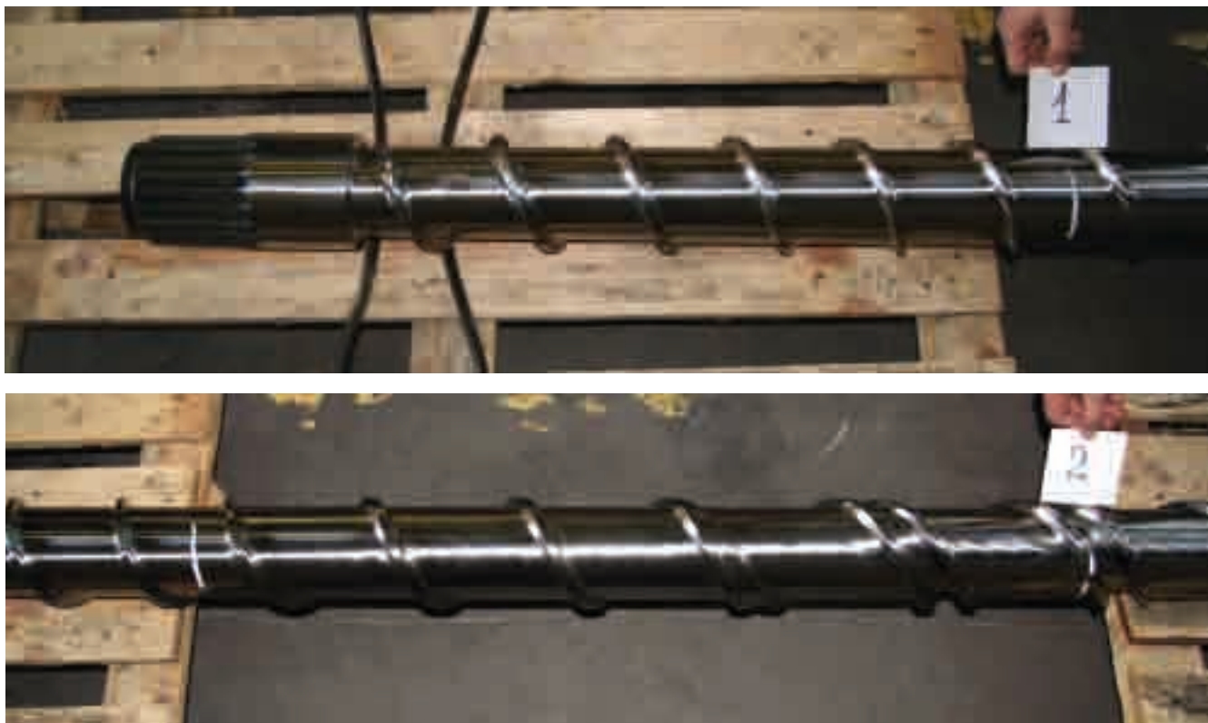
Рис. 1. «Входная» зона шнека. На трех последних витках (нижнее фото) начинается «барьер»
