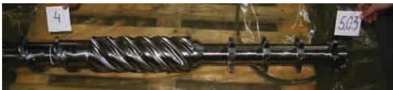
Рис. 4. «Гомогенизирующая» зона шнека
