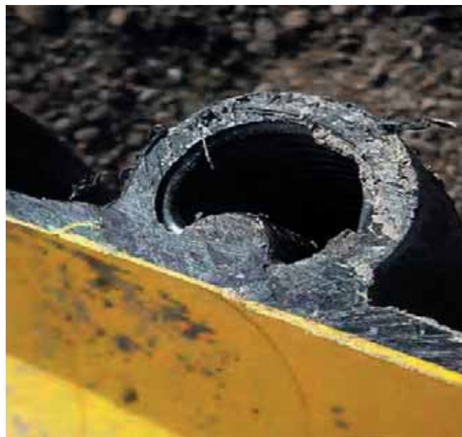
Рис. 3. Излом опорного шланга
