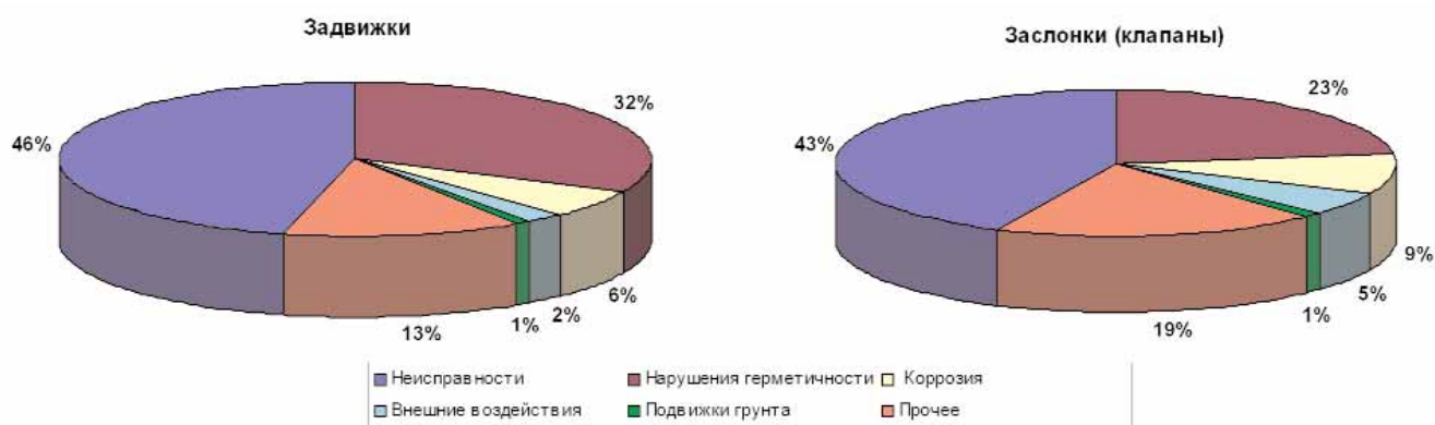
Рис. 1. Причины отказов трубопроводной арматуры за период 1997-2004 гг. (по данным DVGW)
