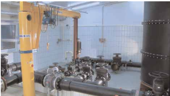
Рис. 6. Стенд для проведения динамических испытаний арматуры при рабочих давлениях до 16 бар и с расходами до 250 м³/ч.
