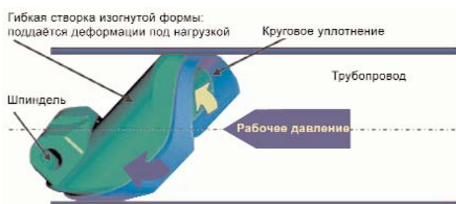
Рис. 5. Клапан гибко адаптируется к контуру уплотнения. Из эластомера выполнена только окантовка створки клапана.
