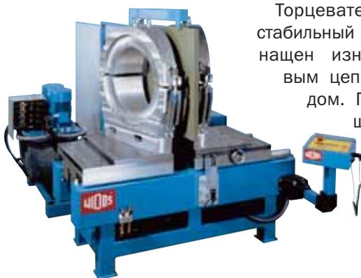
альных требований нагревательные элементы могут быть отрегулированы в нескольких зонах, а благодаря новой технологии изготовления отдельных патронов они отвечают максимальным требованиям по качеству в плане распределения температуры. При изготовлении отводов труб с ППУ изоляцией возможно комплектовать машины разделяющимися нагревательными элементами.
