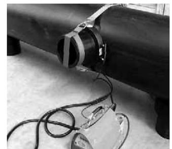
Соединить клеммы сварочного аппарата с адаптерами накладного ухода и установить параметры сварки, считав штрих-код
