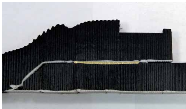
Сварной шов в разрезе
