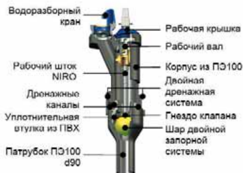
Рис. 2. Конструкция пластикового гидранта
