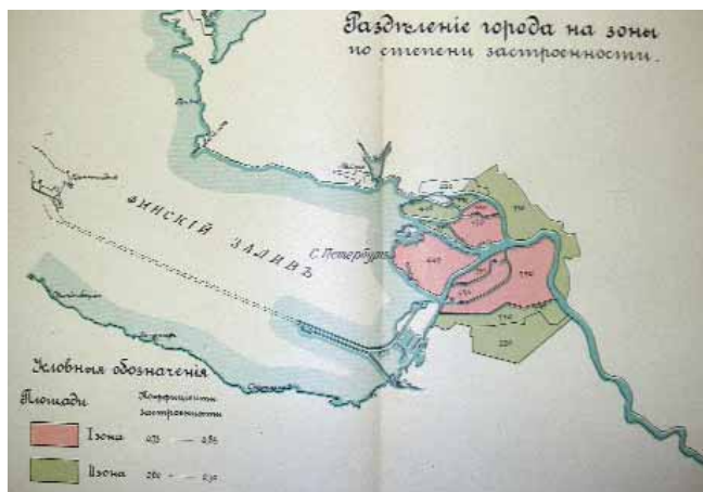
Рис. 7. Разделение города на зоны по степени застроенности. Ливневая сеть. Чертежи из проекта канализации города С.-Петербурга, разработанного под руководством проф. Д.П.Рузского. 1914 г.
