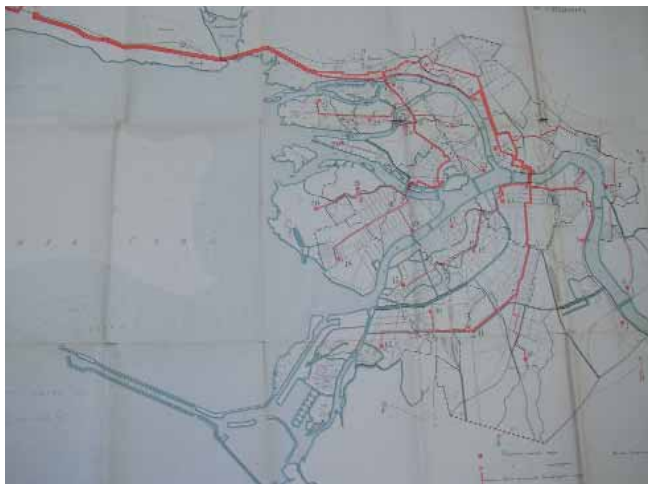
Рис. 6. Схема канализации хозяйственных вод. Чертеж из проекта канализации города С.-Петербурга, разработанного под руководством проф. Д.П.Рузского. 1914 г.
