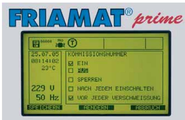
Рис. 11. Отображаемый на дисплее запрос о вводе данных для их протоколирования.
