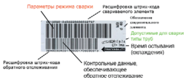
Рис. 2. Штрих-код с параметрами режима сварки и данными обратного отслеживания.
