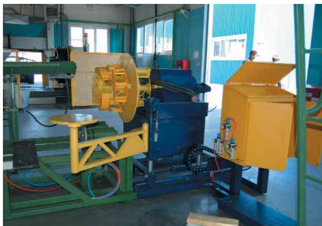
Установка приварки муфт на трубу КОРСИС
