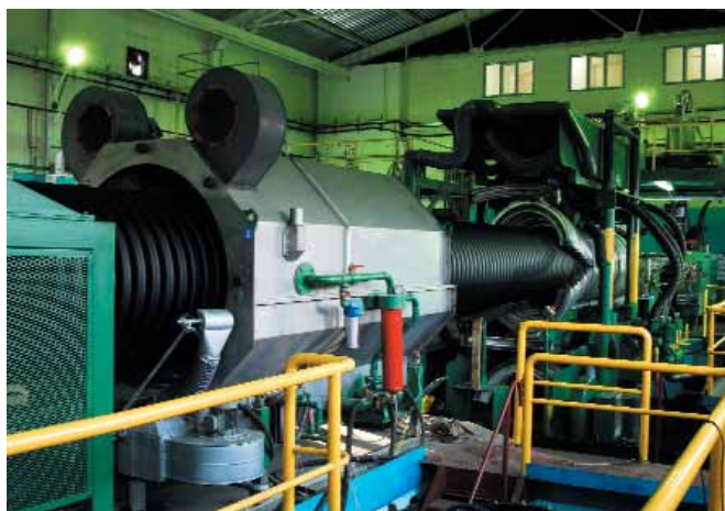
Установка приварки муфт на трубу КОРСИС
