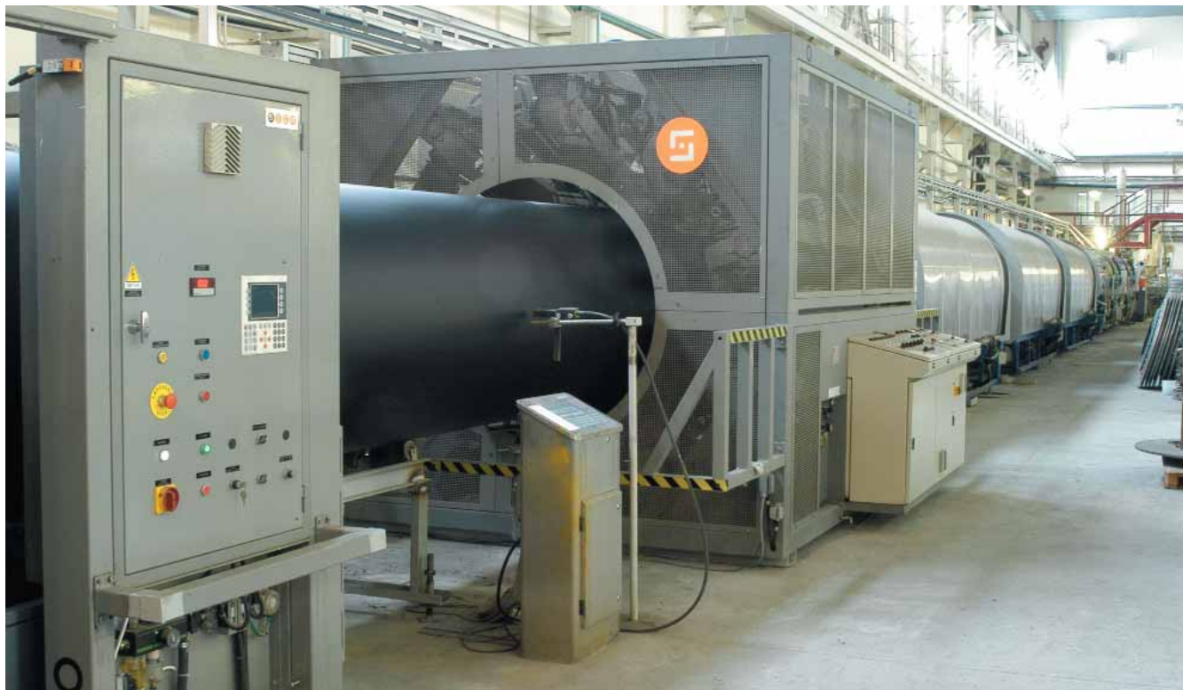
Линия по производству труб до 1200 мм
