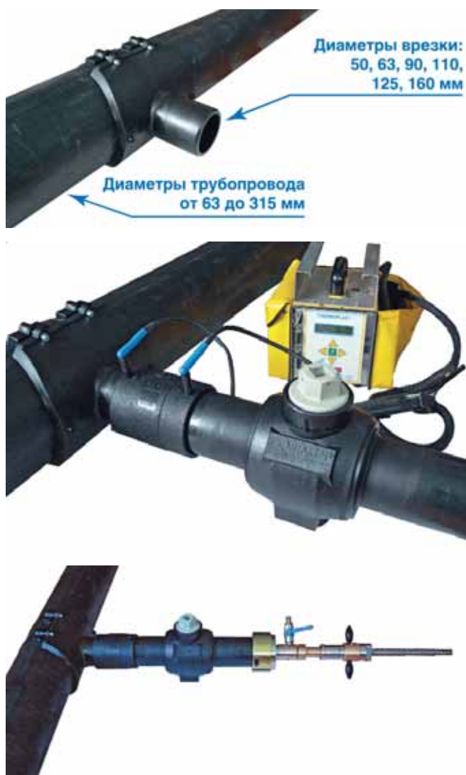
Рис. 1. Устройство «Перфект» для врезки в ПЭ трубопроводы под давлением
