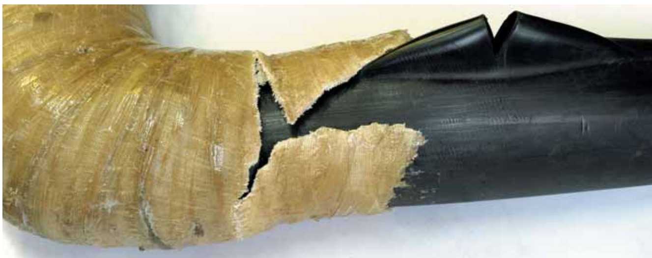
Рис. 3. Характер разрушения отвода при давлении, в три раза превышающем рабочее. Разрушение происходит по подсоединенным трубам, а не по телу отвода
