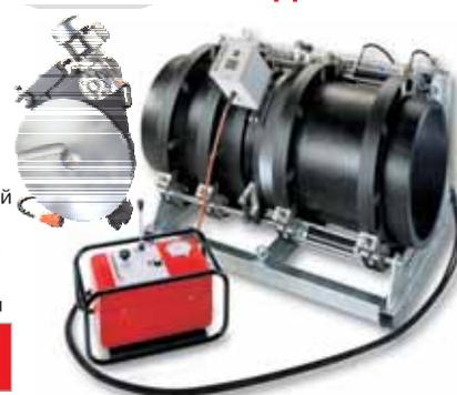
Диаметры свариваемых труб: 315 - 630 мм
