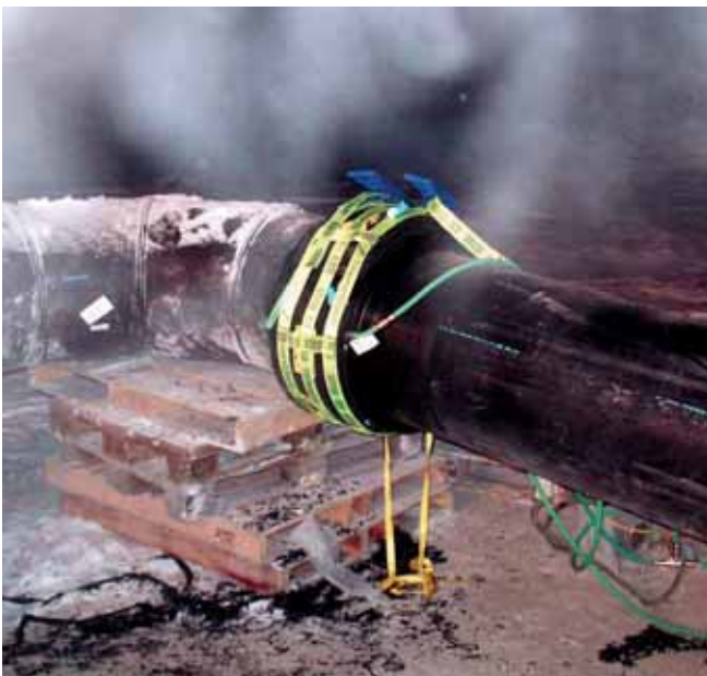
Рис. 10. Полевые испытания по диаметру 560 мм на «Холодном Севере» («Cold North»)
