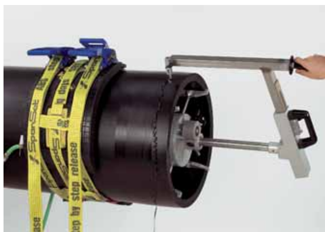
Рис. 8. Вращающееся устройство для зачистки RTC 710
