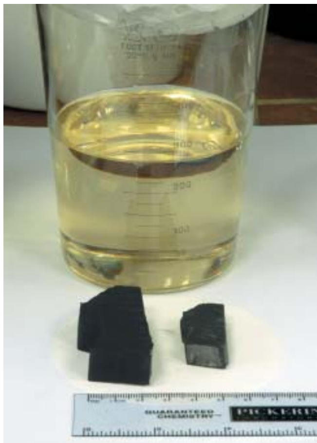
Изменение размеров элементов ПЭ трубы из трубного (в) и трубного сшитого (г) полиэтилена после 24 часов набухания в толуоле
