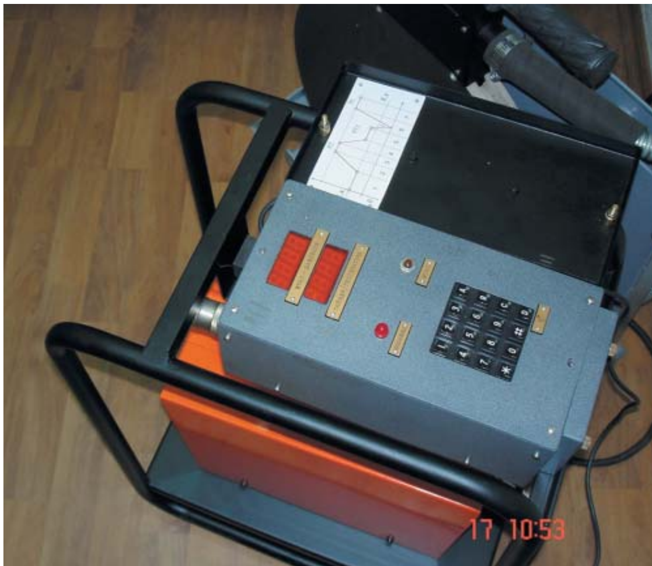
Рис. 2. Блок регистрации параметров сварки КПТЭП
